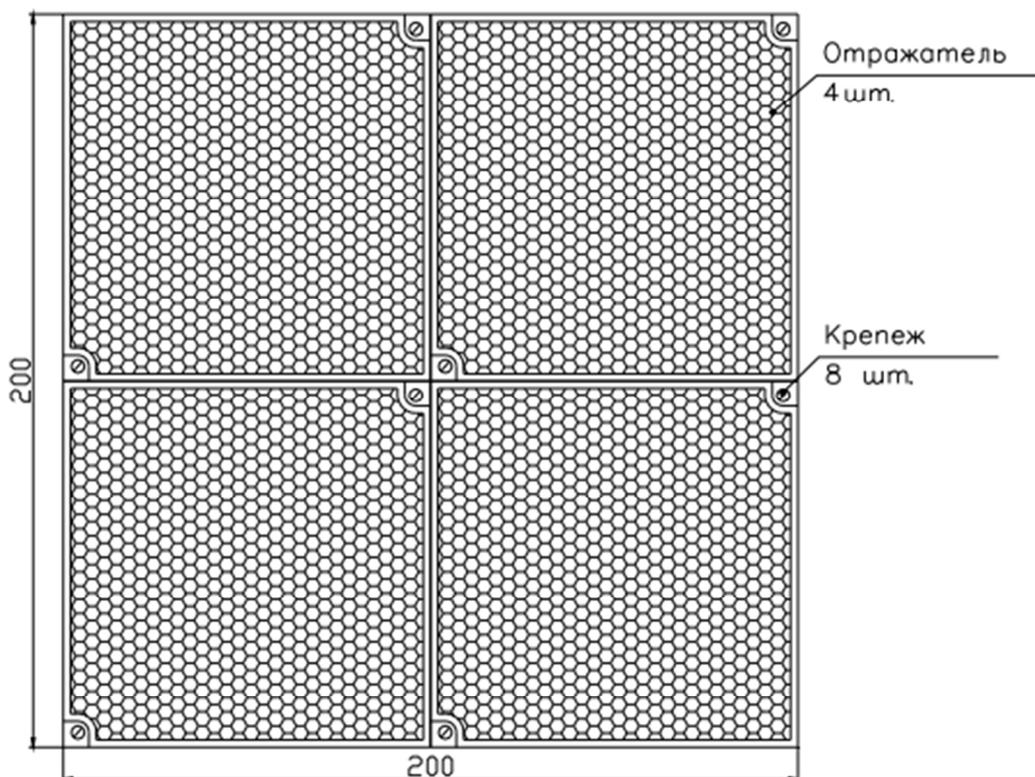
Рисунок 2 - Общий вид пластины со смонтированными на ней четырьмя отражателями
