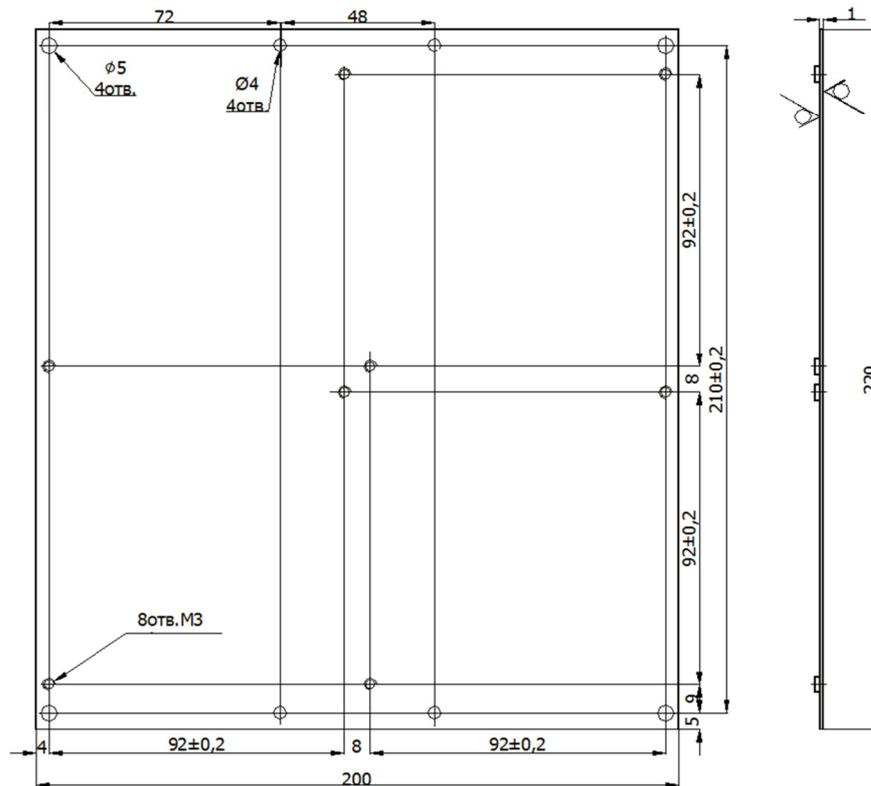
Рисунок 1 - Общий вид пластины для установки четырех отражателей
